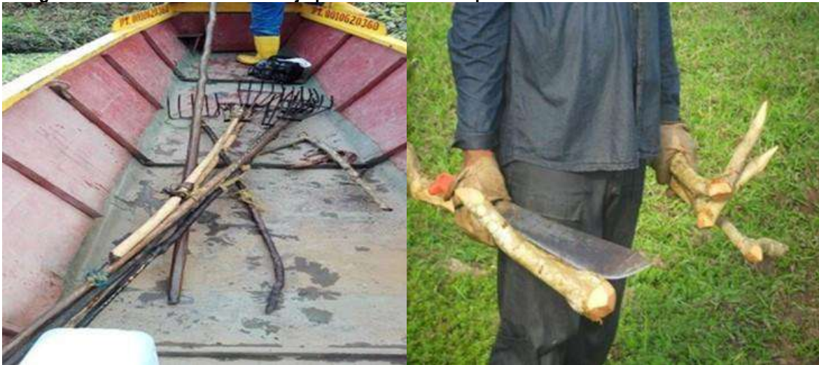
Fotografía 10. Herramientas de trabajo para remoción de tapones flotantes.
