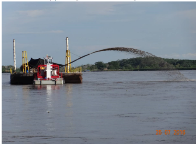
Equipo de dragado con cañón de descarga lateral
